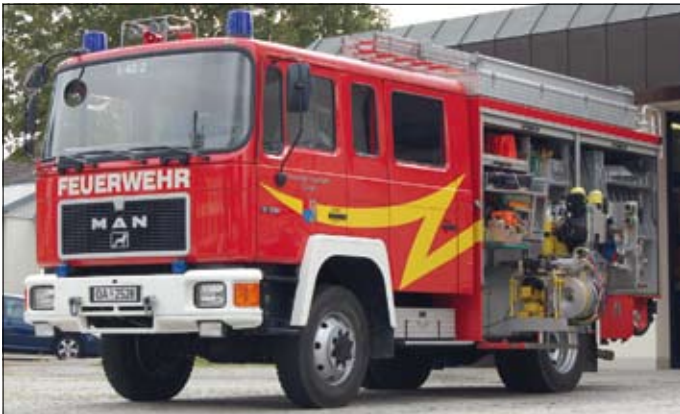
Löschgruppenfahrzeug LF 16/12 – Rufname: Florian Durach 40/2 MAN 12-232, 13 500 kg, Aufbau Metz, Besatzung 1/8, Baujahr 1993 Beladung nach DIN: Lukas Rettungssatz, 1 200 Liter Wasser, TS 8/8 Ziegler Ultrapower, Stromerzeuger 8 kVA, mechanischer Lichtmast, integrierte Pumpe mit 1 600 Liter/min
