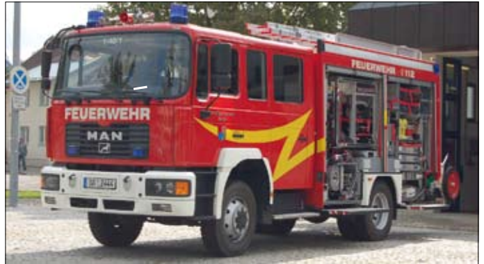
Löschgruppenfahrzeug LF 16/12 – Rufname: Florian Durach 40/1 MAN 14-280, 14 000 kg, Aufbau Ziegler Alpas, Besatzung 1/8. Baujahr 2005 Beladung nach DIN: Lukas Rettungssatz mit hydraulischen Rettungszylindern, 2 000 Liter Wasser, 100 Liter Schaum, Schaummittelzumischanlage, Stromerzeuger 13 kVA, pneumatischer Lichtmast, Verkehrssicherungshaspel, Gasmessgerät, Pumpe 1 600 Liter/min
