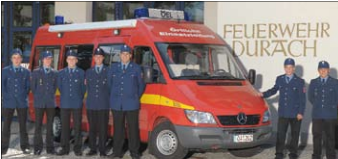
UG-ÖEL, Landkreis Oberallgäu Einsatzleitwagen ELW 2 – Rufname: KATER Oberallgäu 12/1 Mercedes Sprinter, Aufbau Langner, Besatzung 1/3, Baujahr 2005 Beladung: Computer, Funk, Notstromaggregat, Leuchtballon (Powermoon), Komm-Koffer, aufblasbares Schnelleinsatzzelt
