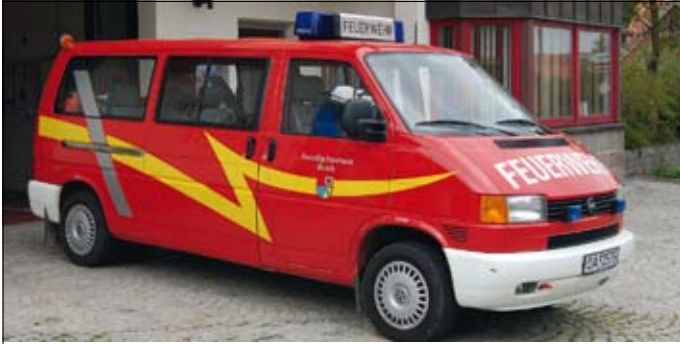
Mehrzweckfahrzeug MZF/ELW – Rufname: Florian Durach 11/1 VW Transporter T4, Besatzung 1/7, Baujahr 1997 Beladung: Werkzeugschrank, Material zur Verkehrsabsicherung
